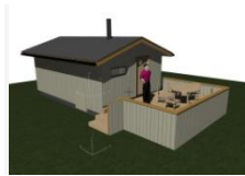
Kuva 10. Kömmeli; Päästötön (ei lämmityskuluja) ja talokohtainen kompostorin päällä istuttava wc-astia, ja suihkun viemärivereden käsittely pihalla. Talo on rekalla siirrettävissä, kahdessa osassa. Alapohja on myös kuivausilman kierrolla. Valmistus kasvihuone 7:ssä.
